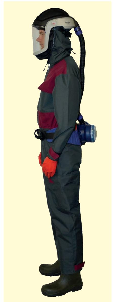
Komplette PSA mit Gebläseatem-schutz. Gebläseatemschutz ist die bequemste Lösung für die meisten Anwendungen. Wichtig ist eine ausreichende Luftmenge. Moderne Gebläse leisten zwischen 160 und 250 l/min.
