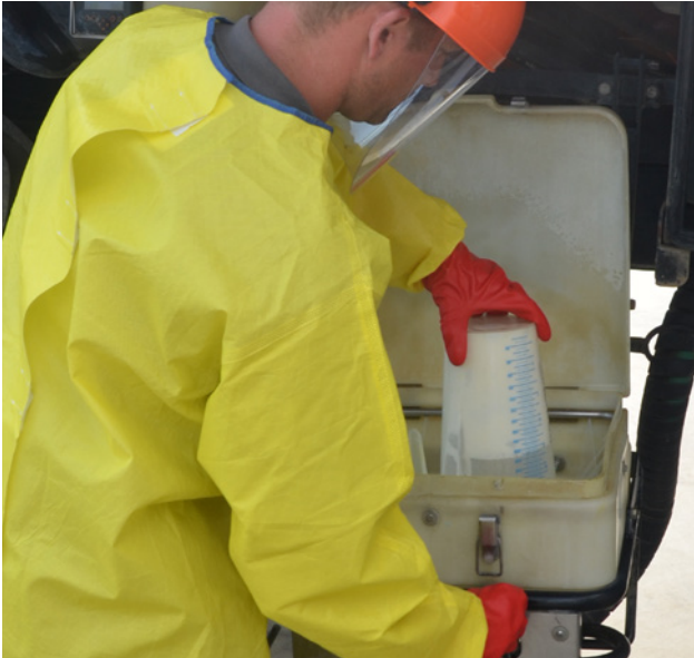
Visier, Ärmelschürze, Handschuhe und Stiefel: Diese Grundausrüstung reicht in den meisten Fällen für ein sicheres Anmischen.
